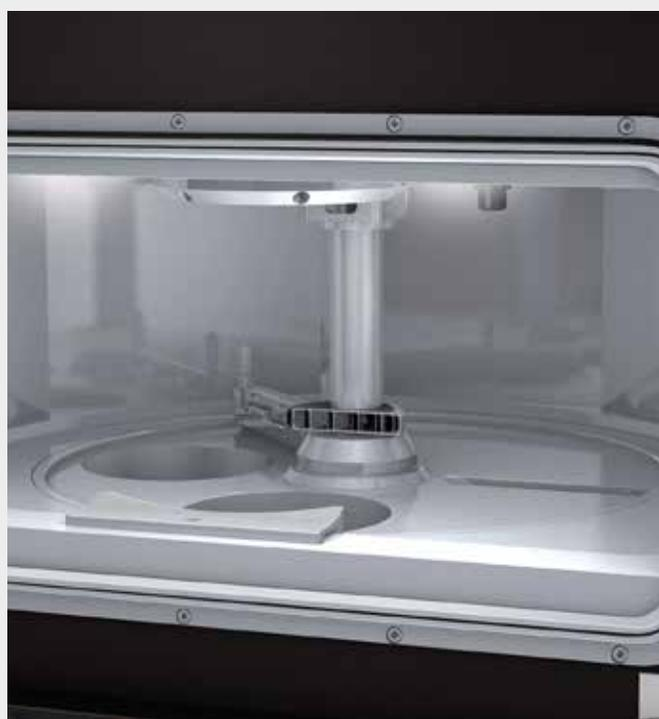
Recubridor rotativo de precisión del 2Create
